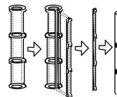
Die Bambuslamellen werden horizontal aneinandergespresst (Plain Pressed) und unter hohem Druck verleimt. Das Ergebnis ist eine Platte oder ein Brett mit den charakteristischen Bambusknoten.
