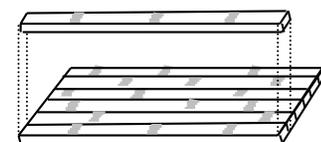
Alternativ zum horizontalen Pressen können die Lamellen auch hochkant gepresst werden (Side Pressed). Hierdurch entsteht ein schmaleres Linienspiel.
